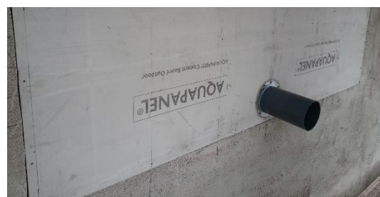
Abbildung 3: Foto der aLT-Feldtestfläche; unteres Ende mit Abdeckung und Lufteinlass (ohne WdVS)
